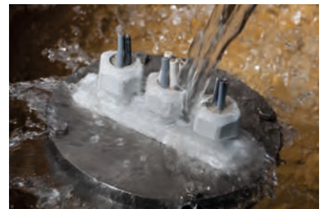
Abb. 2 – der UNI FLANSCH bei der Wasserschutzprüfung Type 4X Fig. 2 – UNI flange during a water ingress test Type 4X
