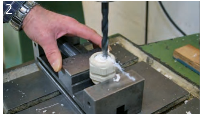
2 Bohrer an gewünschter Stelle positionieren. Bei geringer Drehzahl mit einem handelsüblichen HSS-Bohrer arbeiten.
