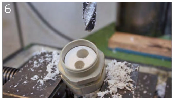
6 Zweite Bohrung in der Ansicht von unten
