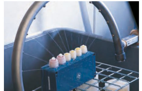
Abb. 1 – PFLITSCH Kabelverschraubungen IP 54 Fig. 1 – PFLITSCH cable gland IP 54
