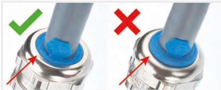
Abb. 1 – Druckschraube anziehen, bis Dichteinsatz und Druckschraube auf einer Höhe sind Fig. 1 – Tighten the pressure screw until it is flush with the sealing insert.
